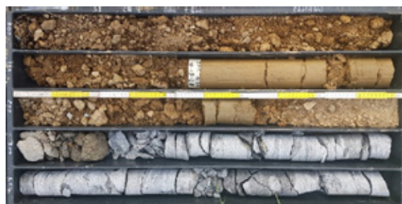
Pianificazione della campagna geotecnica e, sotto, carote estratte dal sondaggio S1.
