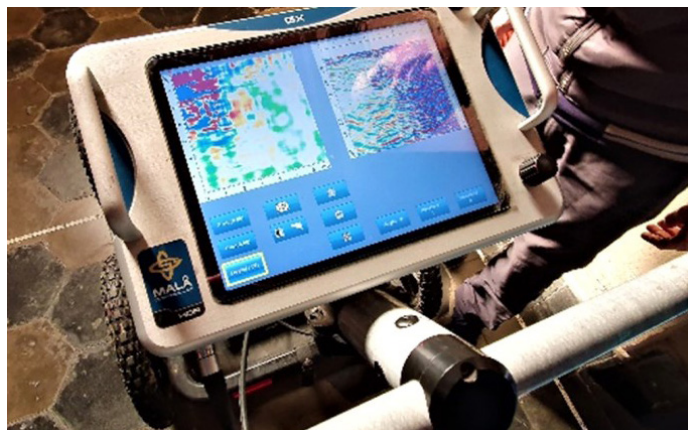
Tomografia elettrica 3D e georadar in esecuzione. A sinistra, una elaborazione dei risultati.
