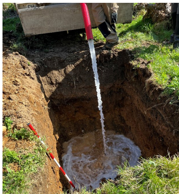
Riempimento del pozzetto di prova
