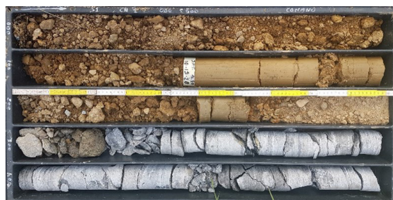
Pianificazione della campagna geotecnica e, sotto, carote estratte dal sondaggio S1.
